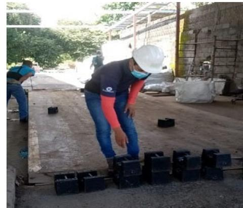
**Calibración de balanzas.** Verificamos calibración de balanzas en piladora Las Mercedes y Recimetal Panamá S,A por reapertura de operaciones, resultado sin anomalías.
